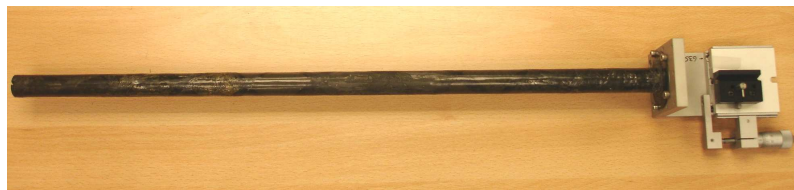
Fig. 1. Dispositivo diseñado para realizar los ensayos con fibras libres.
