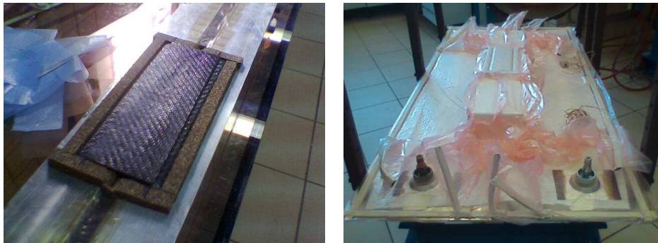
Fig. 3. (a) Cierre con corcho del perímetro de la pieza (b) Bolsa de vacío.
