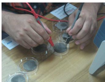
Fig. 1. Medición de la conductividad en una membrana de polipirrol y sustrato de celulosa bacteriana realizada por deposición directa.
