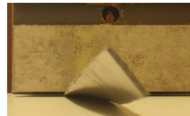
Fig 3. Probetas [45_4/-45_4] donde se aprecian desplazamientos de torsión.
