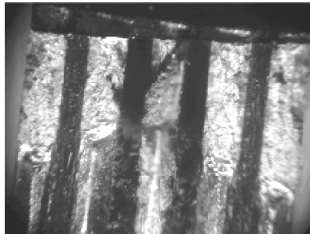
Figura 3. Superficie de fisura por fatiga. Probeta CT tipo 5/4 base Al 1050
