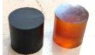
Probetas RTM6 para SPHB (Izq: Grafeno izq, Der: sin grafeno)
