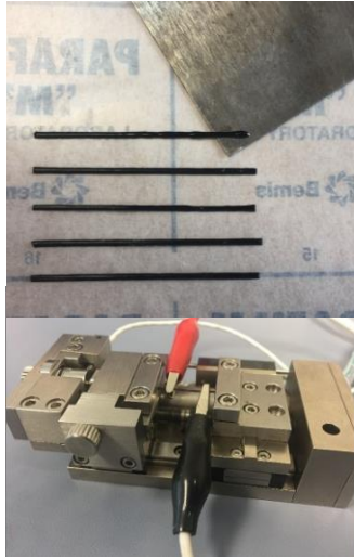
Ensayo de tracción individual de los hilos fabricados por Direct Write
