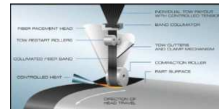
Sistema independiente de rodillos para cada tow
