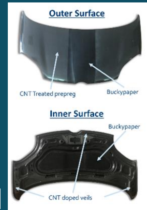
Demostrador Automoción: capó del FIAT Panda (1430mm x 820mm x 130mm)
