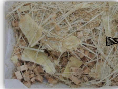
Madera de balsa y fibra de vidrio
