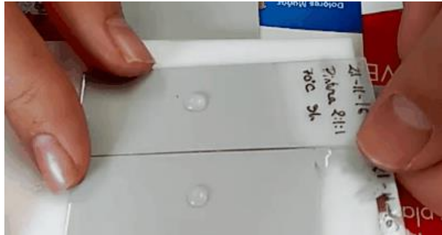
Pintura comercial aeronáutica (arriba) y muestra P/35/0.1 (abajo)
