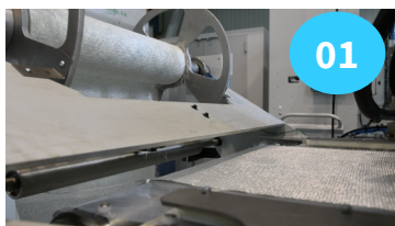
Laminación prepreps sobre molde
