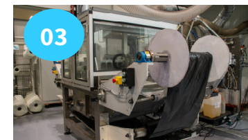
Compactación laminado y curado UV final
