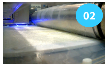
Compactación laminado y curado UV final
