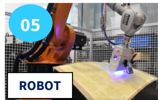
Compactación laminado y curado UV final
