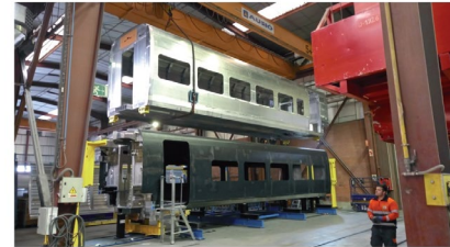
Dos generadores de estructura de caja, aluminio (arriba) e híbrido CFRP/aluminio (abajo) | Camión de T600
