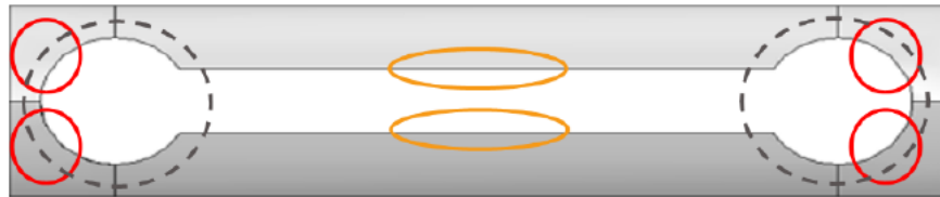
Puntos de concentración de estrés observados.
