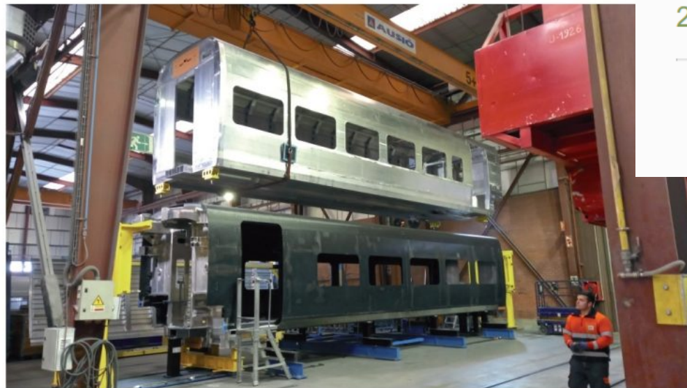
Dos generaciones de estructuras de caja, aluminio (arriba) e híbrida CFRP-Aluminio (abajo) | Cortesía de TALGO
