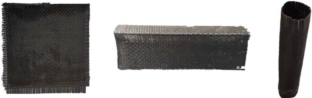
Figura 4: Termoconformado de un laminado fabricado con 4 capas de tafetán adoptando ángulos de 90° y formato tubular.
