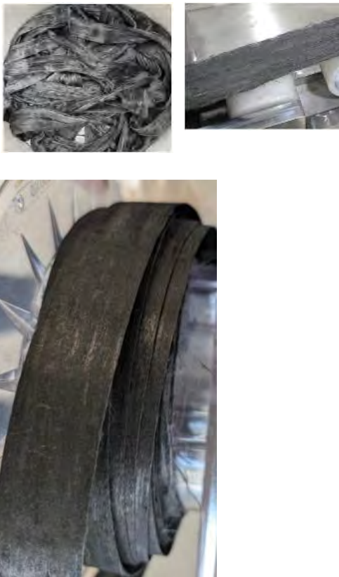
Figura 8: Cinta tape UD con fibra reciclada. De izq. a dcha. Cinta de manual, cinta pre-consolidada, cinta UD tape final. (AITECH centro tecnológico)
