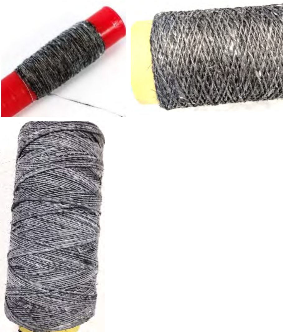
Figura 5: De izq, a dcha, Hilado rCG+PA6 50:50 obtenido por hilatura ring spinning, hilador rCG+PA6 70:30 e hilador rCF+PA6 50:50 obtenidos por hilatura mediante retorsión (AITEK)
