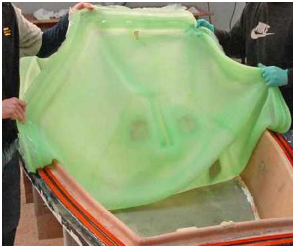
Figura 2: Bolsa o membra de silicona: a) Silicona con forma b) Lámina de silicona. Fuente: Smooth on y Vacform Composites
