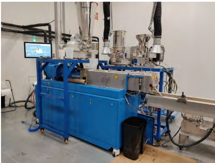
Figura 4: Extrusora Cooperion de doble husillo corotatorios, con sistema de enfriamiento por baño de agua, dosificadores de granza, polvo, fibras y líquidos (Aitiip centro tecnológico)
