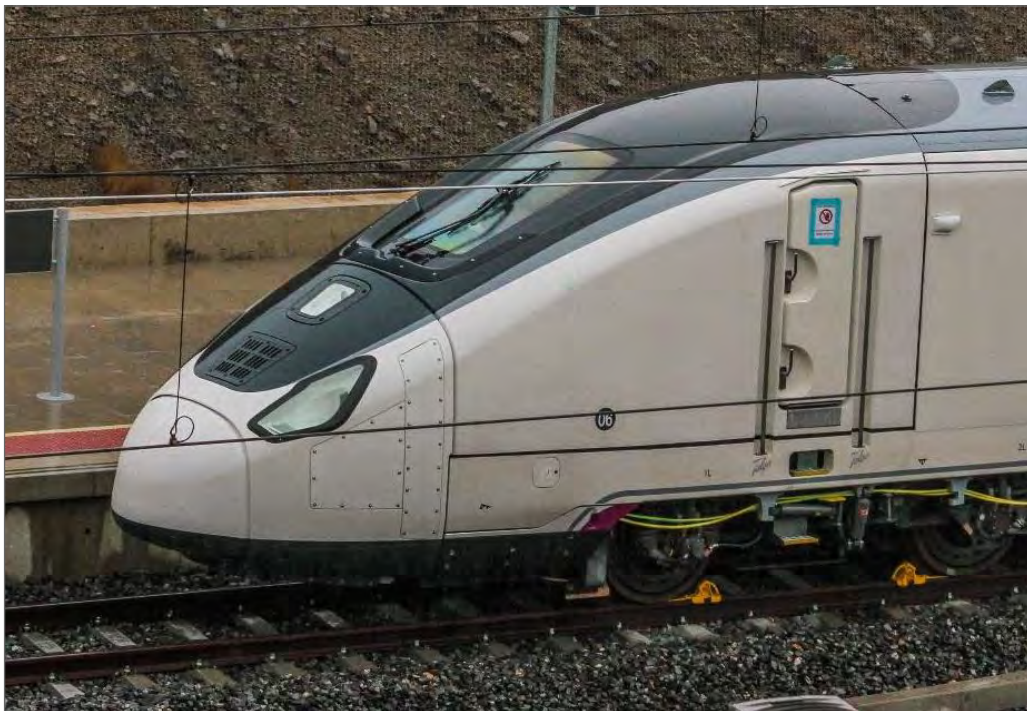
Figura 6: Morro del modelo 106 de Talgo, una combinación de varias piezas de fibra de carbono y resina epoxy y faldón en fibra de vidrio
