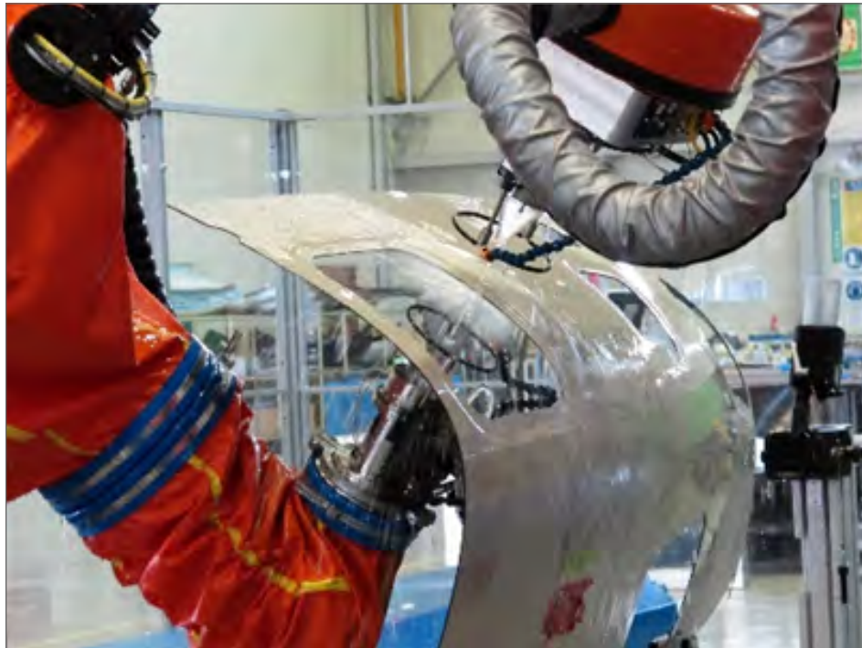
Figura 18: Sistema de inspección no destructivo. Cortesía: Tecnatom
