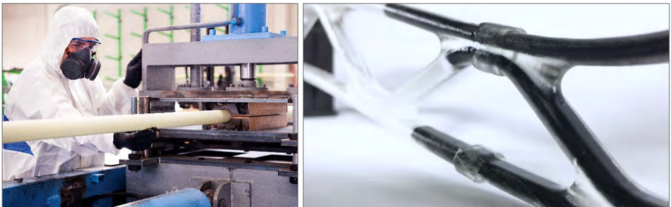
Figura 21: PProcesos hibridados: a) Procesos de pull-braiding, mezcla entre pultursión y braifing. Cortesía de: Birka; b) Procesos de inyección de resina con fibra continua en procesos aditivos. Cortesía: Reinforce 3D
