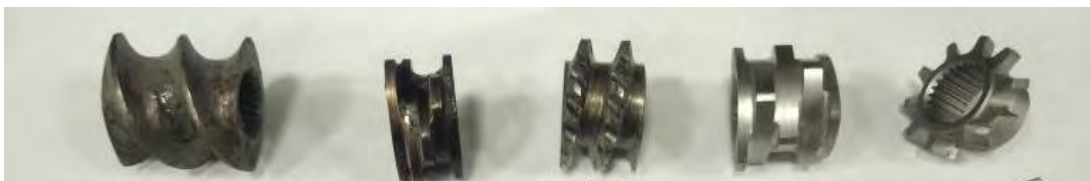
Figura 2: Componentes de husillo utilizados en el proceso de extrusión (Aitiip centro tecnológico)
