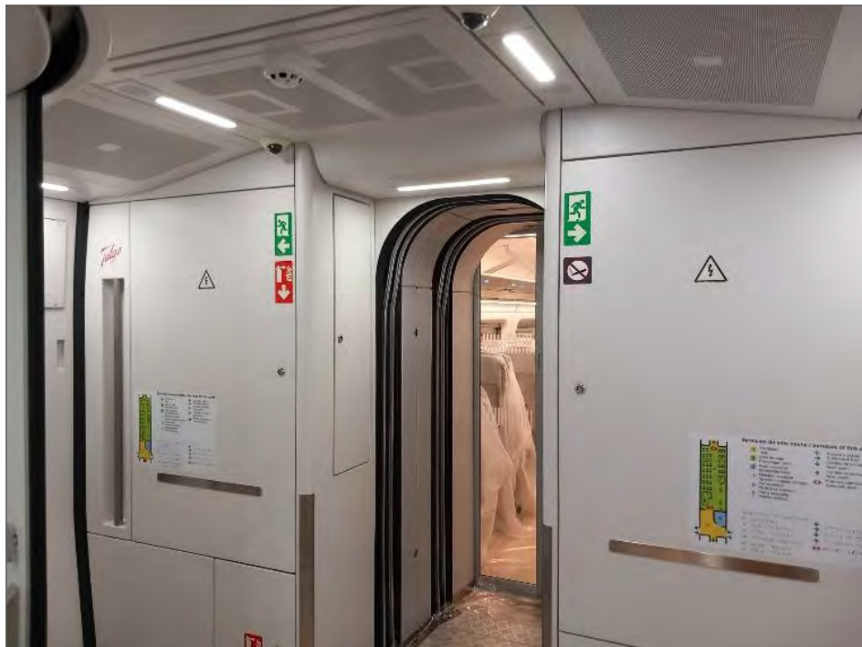
Figura 7: Ejemplo de la carena interior del tren en fibra de vidrio con resina de poliéster con cargas de fuego
