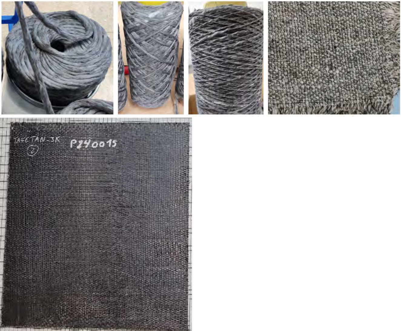
Figura 7: Imagen del proceso de revalorización de fibra mediante tecnologías textiles desarrollados por AITEX (De izq. a dcha. cinta de carda, mecha, hilado, tejido y composite termoplástico)
