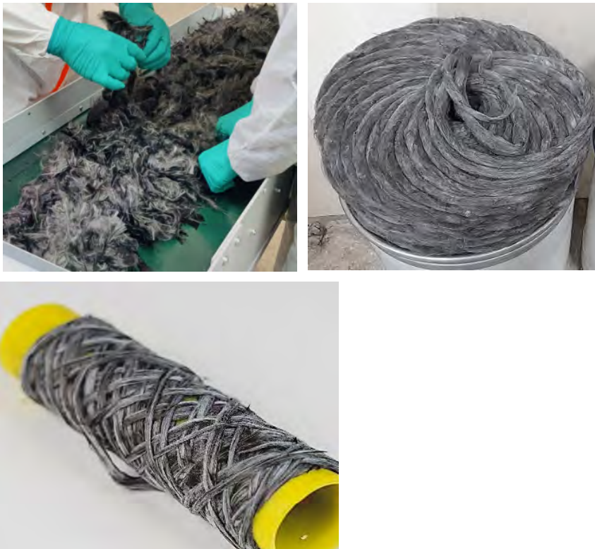
Figura 4: De izq. a dcha. Mezcla de fibra rCF y fibra termoplástica, cinta de carda, mecha de manual (AITEX)
