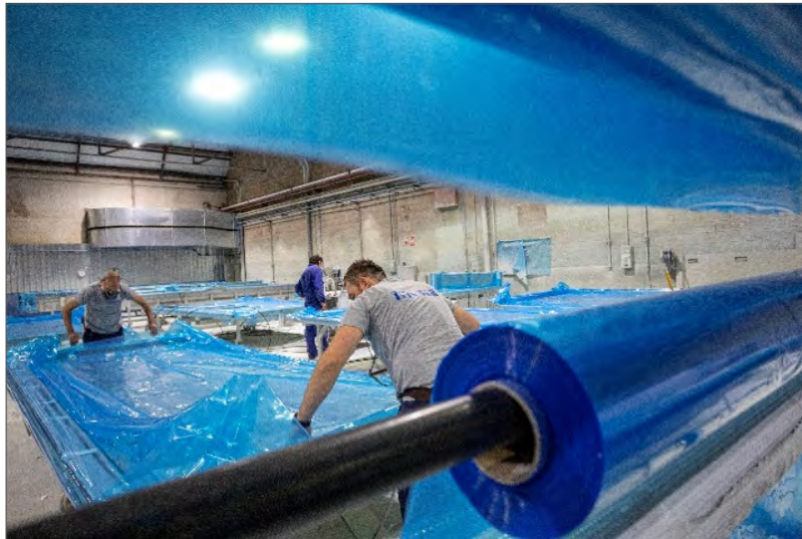
Figura 13: Procesos de laminación manual y preparación de bolsa de vacío. Cortesía: Inpre
