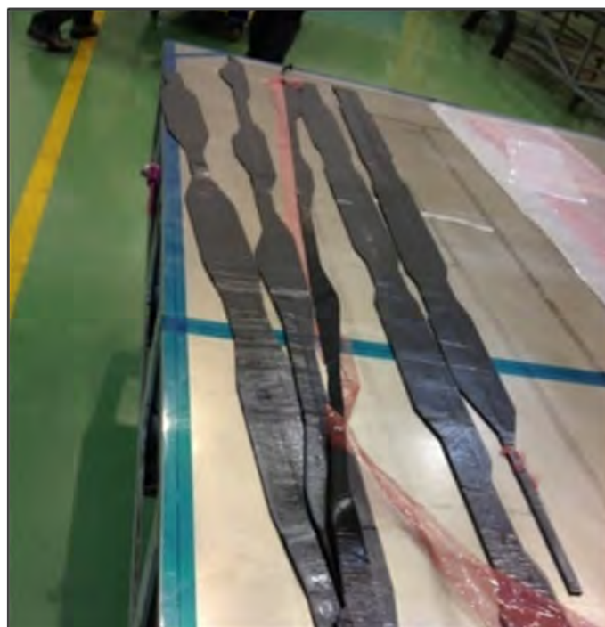
Figura 3: Las imágenes muestran el desecho que se genera al cortar los larguerillos de un estabilizador
