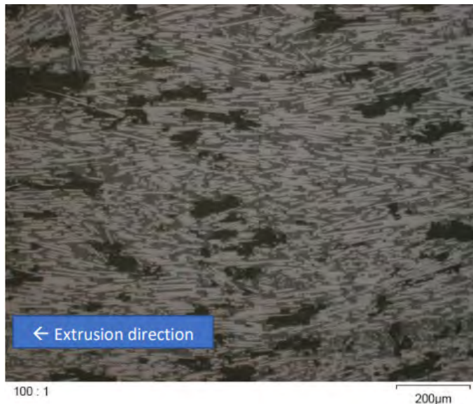
Figura 5: Micrografía de la fibra de carbono extruida, direccionalidad de la fibra durante el proceso de extrusión, obtenida por AIMEN en el proyecto ECOCLIP [25]
